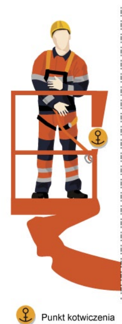
Rys. 4. Punkt kotwiczenia w podnośniku koszowym
